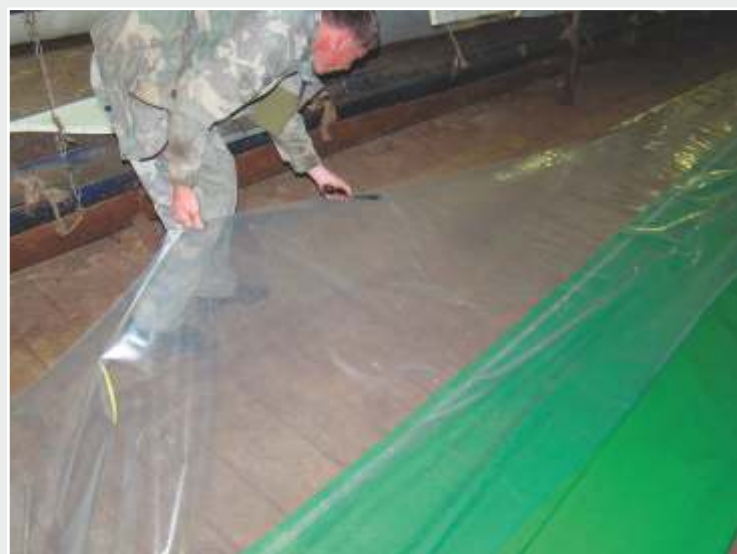
4 разрез рукава пленки (только с одной стороны)
