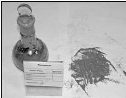
**Микрокремнезем значительно повышает прочность, морозоустойчивость, проницаемость, износостойкость и другие качества многих строительных материалов.**
