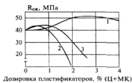
Рис. 10. - Влияние вида и количества пластификаторов на прочность пропаренных бетонов
