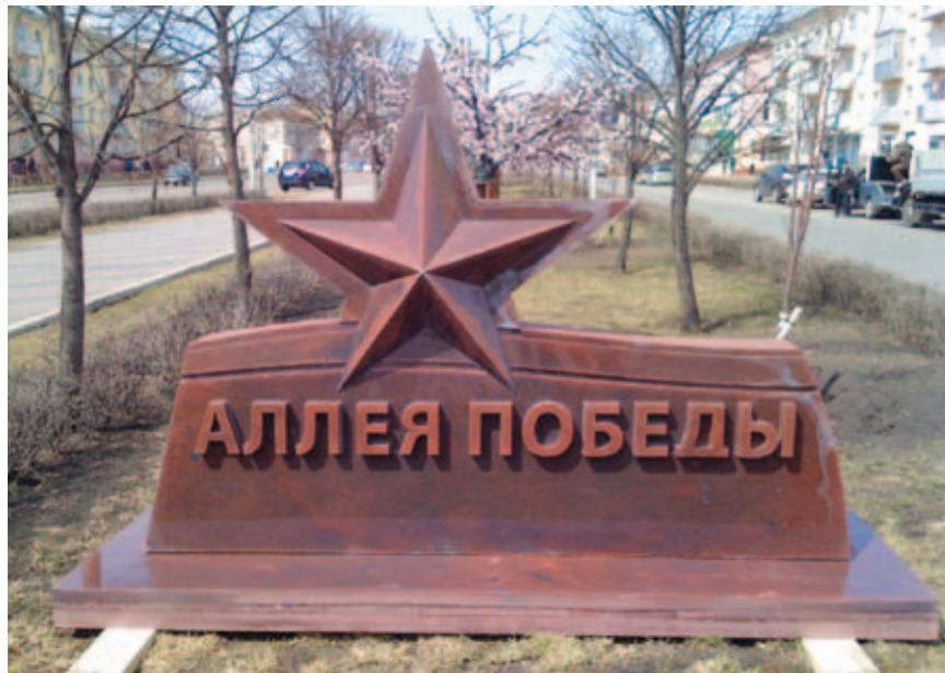
**Рис. 4.** Обелиск из высокопрочного бетона М 1700-200. Сооружен в содружестве с ООО «Новые технологии строительства», г. Красноярск
