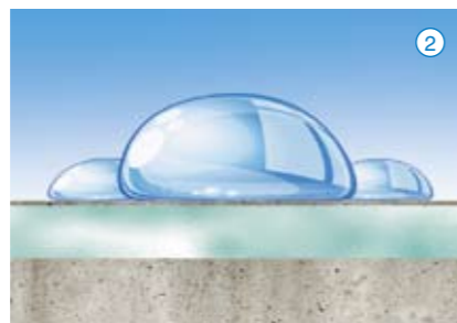
рис. 1. «Водный силикон» при обработке проникает в поры материала (бетона, кирпича) на глубину до 10–15 мм и полимеризуется в нем.
