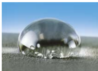
рис. 1. «Водный силикон» при обработке проникает в поры материала (бетона, кирпича) на глубину до 10–15 мм и полимеризуется в нем.
