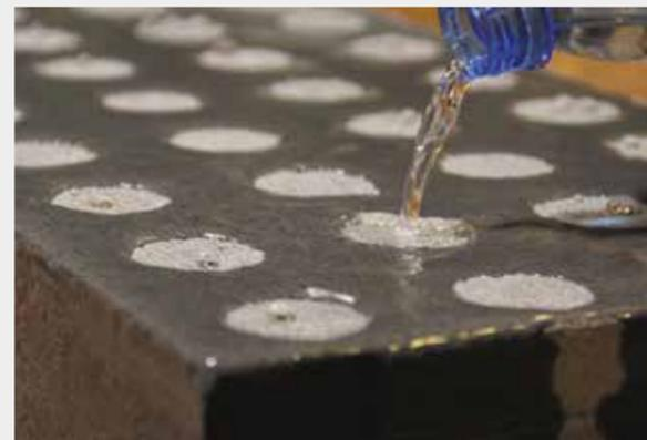
Интенсивное увлажнение образца бетона.
