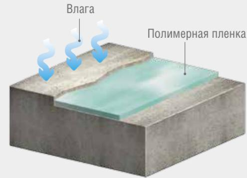
Полимерная пленка «Водного Силикона», находящаяся внутри материала, не пропускает влагу как извне, так и снаружи. Стоимость такой гидроизоляции в расчете на 1 кв.м не дороже полиэтиленовой пленки. Однако срок службы на порядок выше и составляет более 10 лет. Эту полимерную пленку невозможно повредить, только в случае если удаляется сам обработанный материал.
