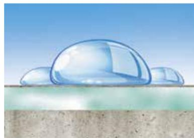
В течении 6–8 часов внутри обработанного материала образуется полимерный слой (пленка), не пропускающий влагу.
