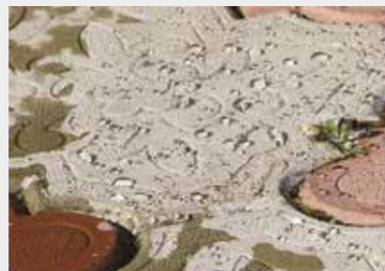
Результат — обработанный участок плитки влагонепроницаем.
