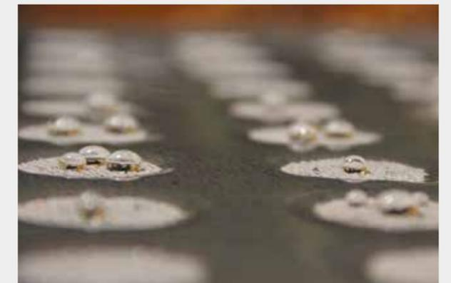
Места бетона, которые были обработаны «Водным силиконом», получили влагонепроницаемость.
